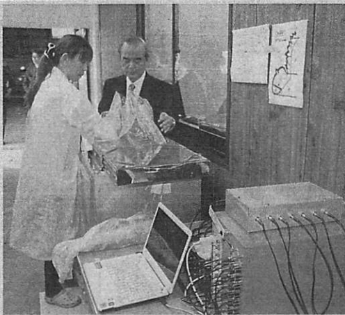
魚を丸ごと入れて放射能を測定する装置
